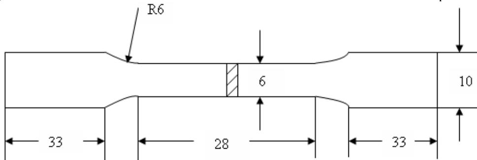
Fig. 4. Tensile Test Specimen
